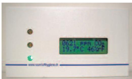
Il permet de donner des repères sur l'état de confinement de l'air et d'inciter à l'aération en cas de besoin.
