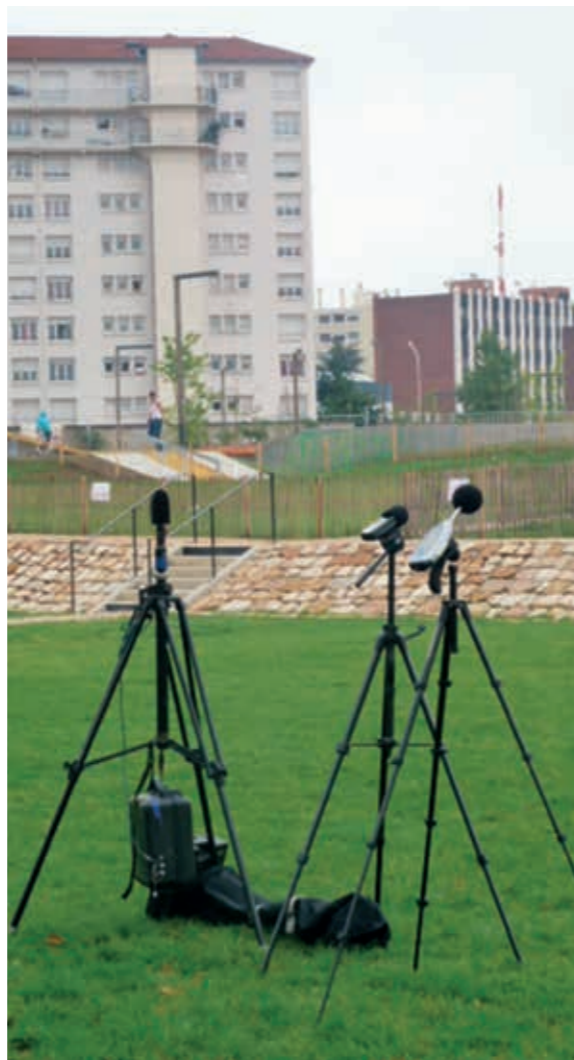
Mise en place pour une mesure de longue durée (24h, 1 semaine ou plus)
